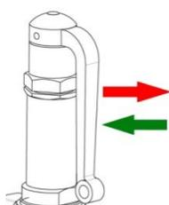
Schritt 1: Anlüfthebel von der Federhaube wegziehen, bis ein deutliches Ausblasen des Betriebsmediums hörbar ist.
