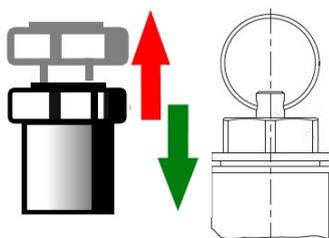
Étape 1 : Tirer le bouton de levage (pull ring) vers le haut, jusqu'à entendre clairement le fluide être propulsé vers l'extérieur.
