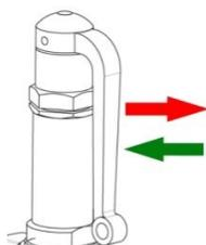
Шаг 1: Оттягивайте рычаг подрыва от пружинной крышки до тех пор, пока не услышите отчетливый шум выхода рабочей среды.
