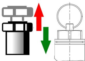
Шаг 1: Потянуть кнопку подрыва / вытяжное кольцо вверх до тех пор, пока не будет слышен отчетливый шум выхода рабочей среды.
