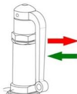
步骤 1：将排气拉杆从弹簧盖罩中拉出，直至可明显听见运行介质排出的声音。
