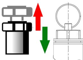
Schritt 1: Anlüftekopf / Pull-Ring nach oben ziehen, bis ein deutliches Ausblasen des Betriebsmediums hörbar ist.
